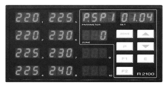
DIN-Format: 192 x 96 mm Installation depth: 122 mm
